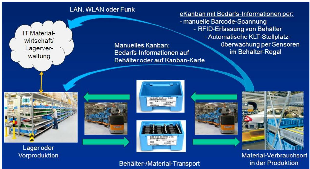
Abbildung 4: Kanban-System zur Fertigungs- und Materialflusssteuerung
