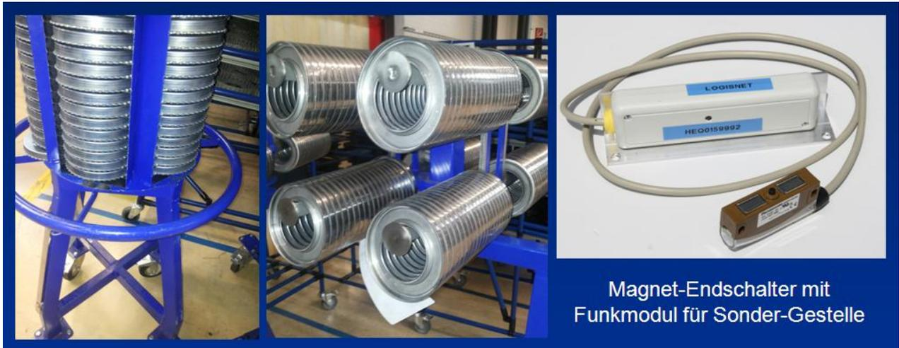
Abbildung 7a: Magnet-Endschalter für Sonder-Gestelle
